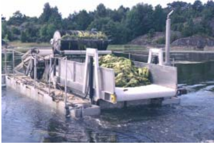
Bild 9. Skördaren med det nya avlastningsbandet, sedd från aktern.
