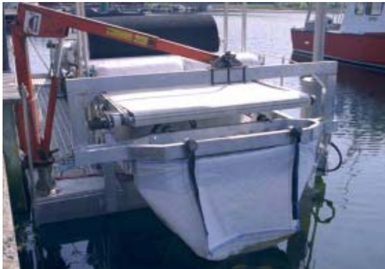
Bild 6. Aktern på skördaren försedd med den galge som håller säcken som samlar upp algerna.
