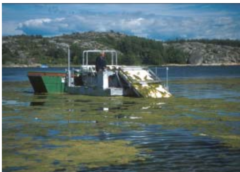
Bild 5. Algskördaren (Kanalgen) i full aktion. I aktern skimtar den container som de upptagna och urpressade algerna uppsamlas i.
