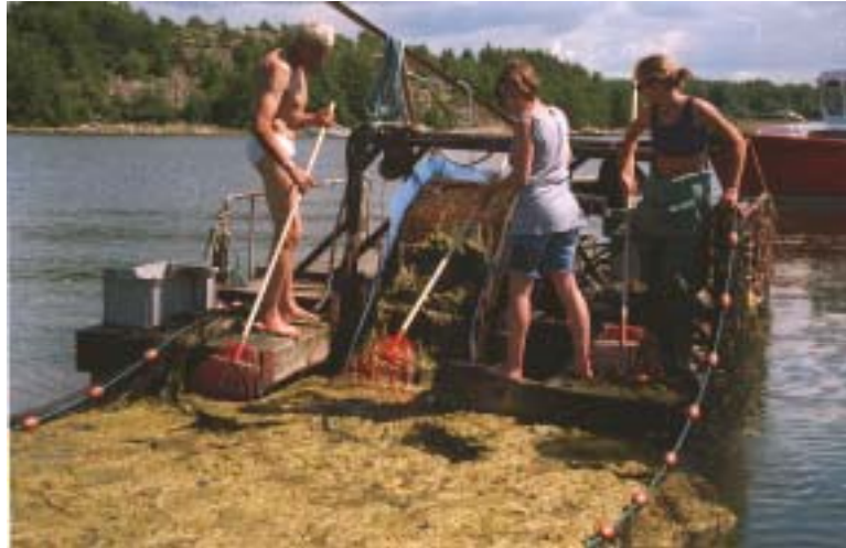
Bild 3. Provisorisk algskördemaskin byggd av en musselupptagare.
