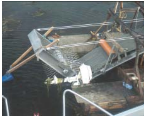
Bild 4 a och b. Bilden a visar det rörliga upptagarhuvudet och bilden b visar upptagarbandet med räfsvals.
