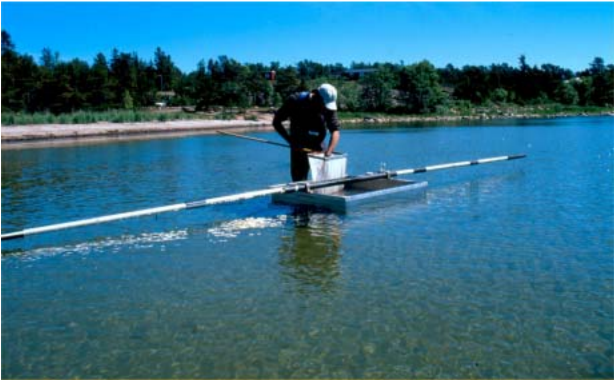
Foto 1. Fallfällan som använts vid epifaunaprovtagningarna (J. Berglund 1998)
