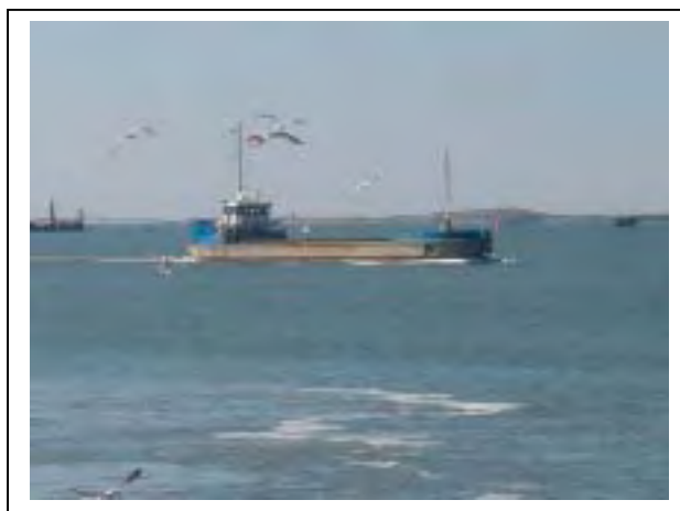
Figur 2. Pråm för transport av sprängsten till reven (pråmvolym 500 m 3 )
