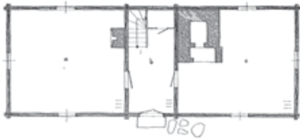
Parstugeplan med genomgående gång, långförstu, som även haft en ingång på husets baksida. Torpane i Gestad socken. Uppmätning OH/INM.
