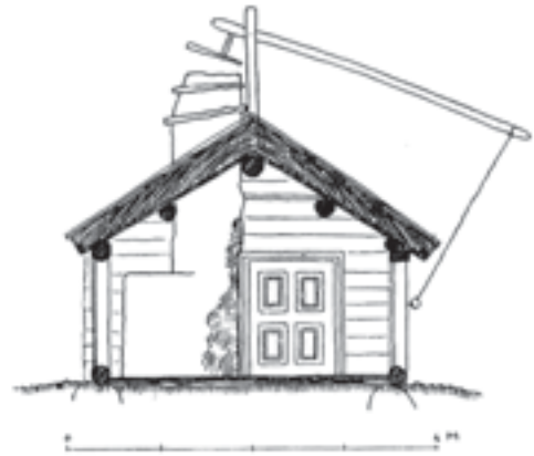
I Dalslandsgårdar har Gösta von Schoultz gjort ett försök till rekonstruktion av en parstuga med torvtak, takfönster och lockspjäll utifrån ett syneinstrument i Krigsarkivet för trumslagarebostället Åsebo i Rännelanda år 1724. Till höger syns en genomskärning av en ryggåstuga med torvtak och lockspjäll från Skogserud, Holms socken. (Ill. Nils Benckert 1919)
