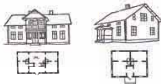
Hus med dubbel bredd. Till vänster syns den sexdelade salsbyggnaden med centralt placerad sal och på sidorna om denna kök och olika kamrar. Till höger syns en variant av det västsvenska dubbelhuset med fyra rum och en liten förstuga placerade runt en central murstock.
