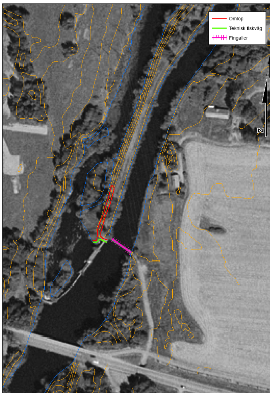
Fig 16. Att få till stånd en genomtänkt fiskväg som fungerar även för svagsimmande arter och som underlättar både upp- och nedströmsvandring rekommenderas vid Katrinefors. Exempellösning och Illustration: Niklas Egriell och Daniel Mattsson. Bakgrund: Länsstyrelsens ortofoto.
