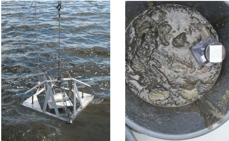
Figur 7. Huggare av typen Smith McIntyre med provtagningsyta 0,1 m 2 samt det osållade provet.
