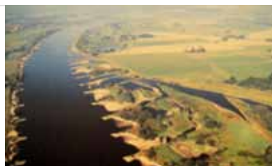
Figur 112. Ledväggar längs floden Elbe – Tyskland.
