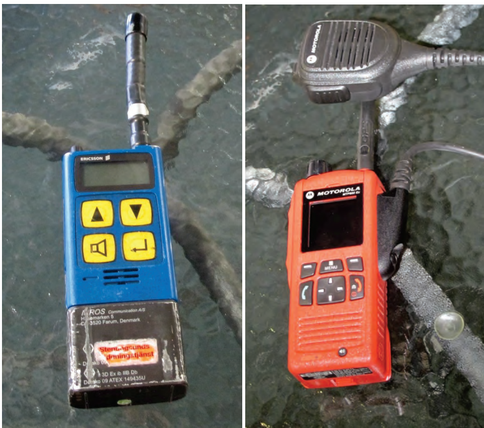
Bild 3: ATEX-klassad radioutrustning hos Stenungsunds räddningstjänst. Äldre modell (t.v.) ersätts av ny RAKEL-modell (t.h.).
