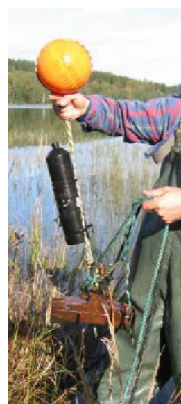
Figur 4. Hydrofonboj "VR2" med flytkula som håller systemet upprätt och ankarvikt.
