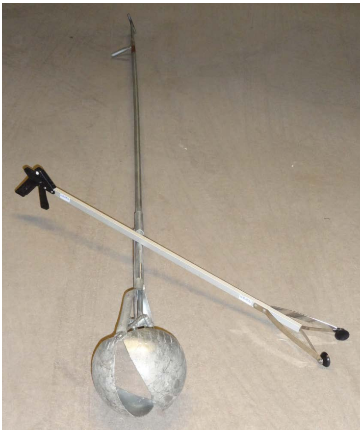
Figur 1. Provtagningsutrustning. Skräpsamlare och rensskopa Foto: Fredrik Nilsson.
