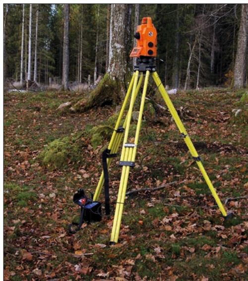
Figur. 4. Geodimeter 600. Den här typen av totalstation är ofta det enda alternativet vid detaljkartering av fossil åkermark i skogbevuxen terräng.
