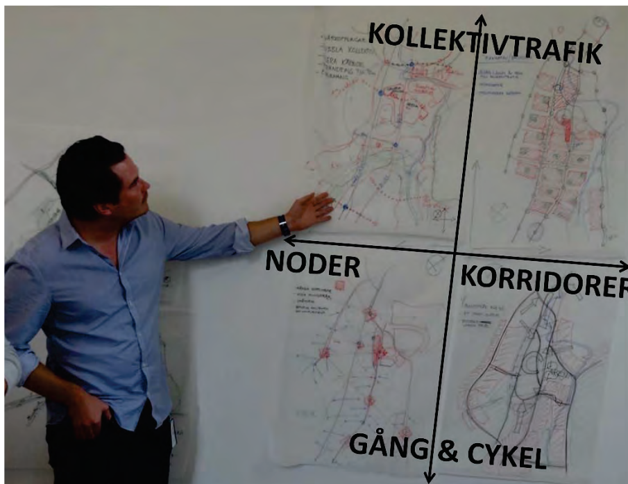
Figur 12: I detta transportexempel har en rumslig dimension (utveckling i korridor eller noder) kombineras med olika skalor i transportsystemet (kollektivtrafik respektive cykel). Foto: Ulf Ranhagen.
