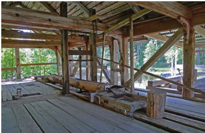
▲ Holmens kvarn- och såg (till höger i bild), damm, bostadshus m.m. Kalmar län. Foto: Coco Dederig ▼ Enbladig ramsåg. Foto: Thomas Carlquist
