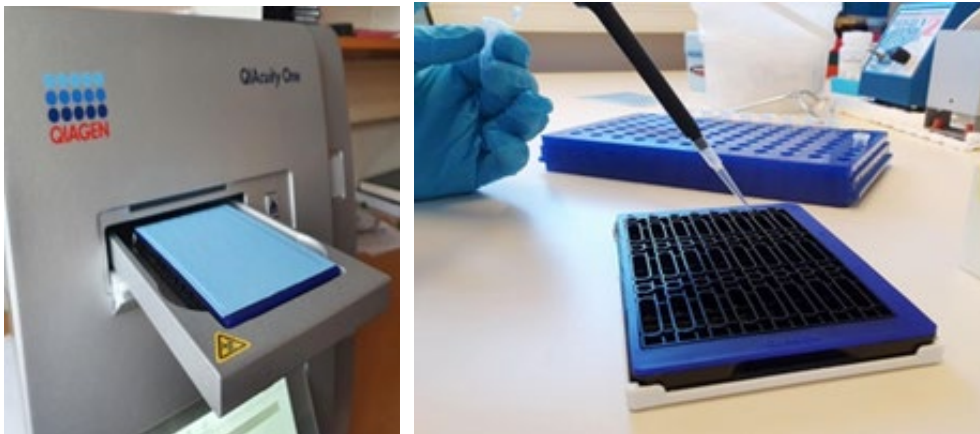
Figur 5. QiAcuity One systemet och den typ av 24-plattor som använts (Foto: Alizz Axberg © ).
