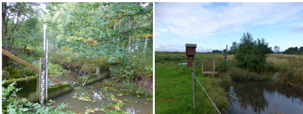
Figur 4. Triangulärt överfallsvärn med tryckgivare för registrering av flödet vid område O14 (vänster) och O17 (höger). Foto: Lisbet Norberg
