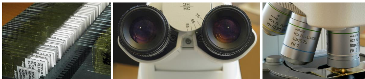
Figur 1. Prover för kiselalgsanalys prepareras kemiskt och kvarvarande kiselalgsskal fixeras på objektsglas till permanenta preparat, som sedan kan analyseras i ljusmikroskop i 1000 gångers förstoring. Mikroskopet ska helst vara utrustat med interferenskontrast, vilket gör att man kan se mycket små former tydligare än med andra tekniker.
