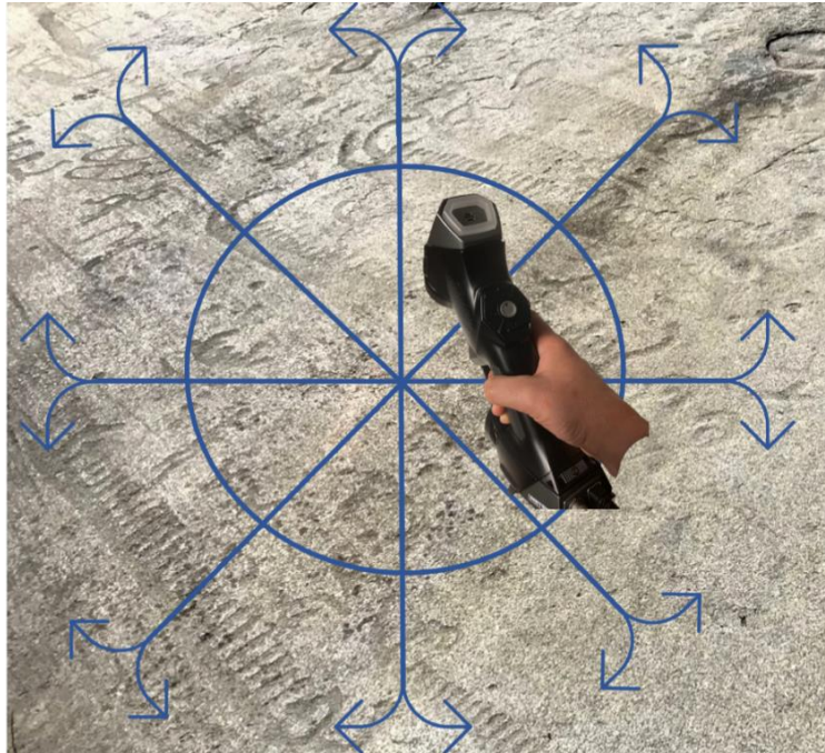
Figur 2. Enligt spiderwebb-tekniken skannas objektet från mitten och sedan utåt kanterna. Illustration: Länsstyrelsen Västra Götaland.
