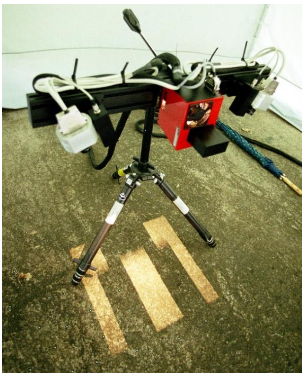
Figur 22. ATOS och det projicerade ljusmönstret på hållen. Foto: S-O Johansson, Metimur AB 2001.
