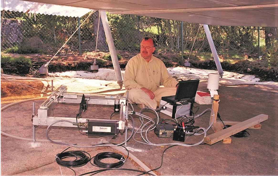
Figur 16. Jan Swantesson mikrokarterar bergytan med den första 3D-skannern. Foto: Jan Magnusson, Länsstyrelsen Västra Götaland 2000.
