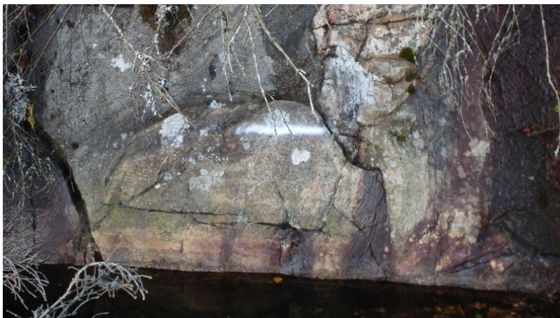
Vinsarpasjö Vattenstånd uppmätt vid stor sten i sjöns nordöstra del, strax norr om ilägg. Koordinat 6422526/1366012. Vattennivå 63 cm under stenens högsta höjd.
