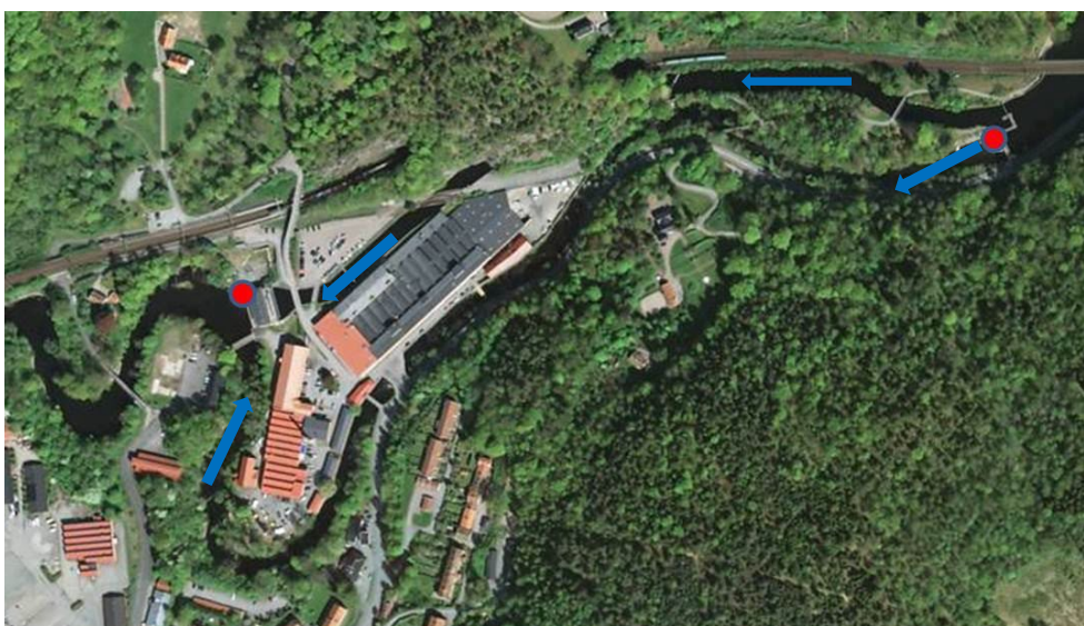
Bild 1. Kraftverket vid Jonsered i Sävån. De två fiskvägarna är markerade med röda prickar (Jonsreds nedre fiskväg till vänster i bild och Jonsreds övre i naturfåran till höger). Blå pilar anger flödesriktningen i de olika vattenfårorerna.
