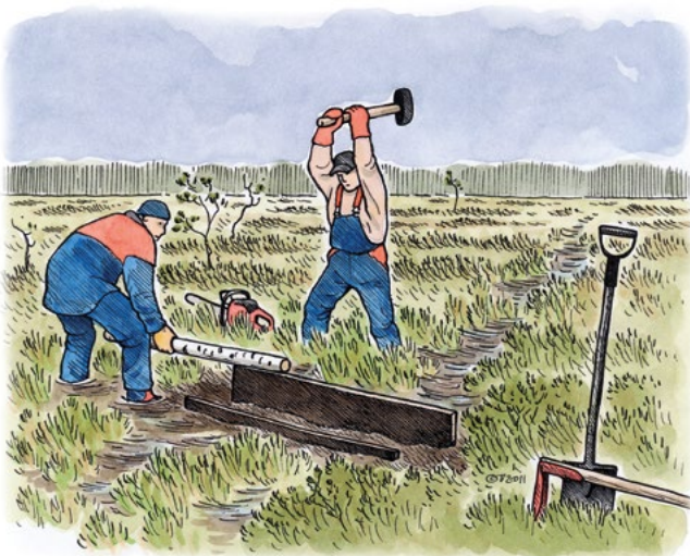
Figur 4.17. Exempel på en enkel typ av dämme för placering i mindre diken där det inte är lämpligt eller ekonomiskt rimligt att ta sig ut med maskiner. Dämmet utgörs av två skivor av hållbar, 20 mm tjock, plywood vars höjd och bredd överstiger dikets bredd och djup med cirka 0,5 m. Mellanrummet mellan skivorna fylls igen med tillgängligt material intill diket, exempelvis torv från myren och packas samman (illustrationer: Tupu Vuorinen).
