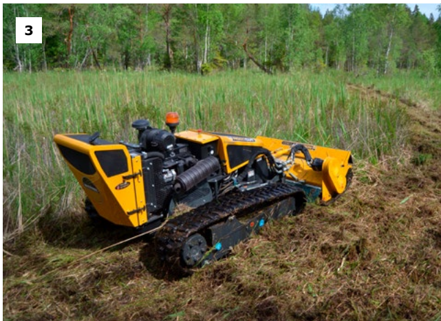
Figur 8.10. Olika maskiner för fräsning av stubbar, sly och tuvor. Bild 1. Fjärrstyrd redskapsbärare. Här utrustad för fräsning av vegetation i blivande stängselinjer, Green Climber 50 hp (foto: Jennie Niesel). Bild 2. Fjärrstyrd stubbfräs som kan fräsa ner under marknivå med en mera smal roterande frässkiva, Rayco RG45X-R (foto: Jennie Niesel). Bild 3. Fjärrstyrd fräs för klena stubbar, slystubbar och tuvor, Robocut 1300 (foto: Tomas Troschke). Bild 4. Manuellmanövrerad redskapsbärare BCS 650 Max utrustad med fräsningsaggregat för tuvfräsning (foto: Tomas Troschke).
