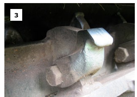
Figur 8.9. Pistmaskin, samma modell som i fig 8.8. Fräsning av stubbar till marknivå med pistmaskin. Bild 1. Pågående stubbfräsning. Bild 2. Fräsaggregat. Bild 3. Närbild på frästand (foto: Jesper Hansson).
