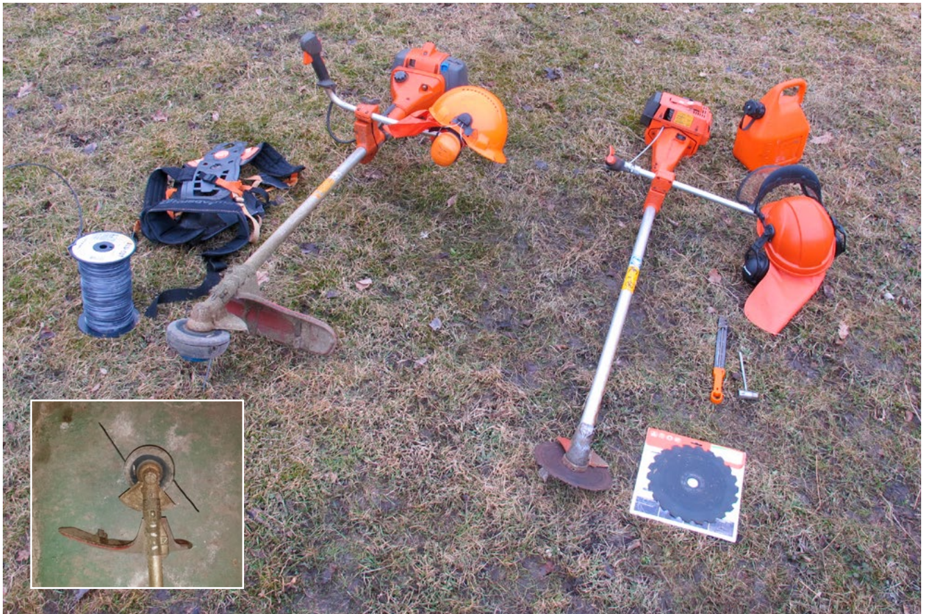
Figur 8.2. Utrustning för motormanuellröjning och slåtter. Röjsågen till vänster är utrustad med trimmerhuvud för grässlåtter och röjning av mycket klen sly (<1 cm i diameter). Trimmerhuvudet, infällt nere till vänster, måste kontinuerligt fyllas på med ny trimmerlina vartefter den nöts ner. Till höger ses en röjsåg utrustad med vanlig röjsågsklinga för slyröjning. Utöver det ses röjsågsssele, fil med mall, hylsnyckel, hjälm med visir och hörselskydd och bensindunk. Observera att man alltid ska ha visir eller skyddsglasögon vid användande av röjsåg (foto: Jesper Hansson).
