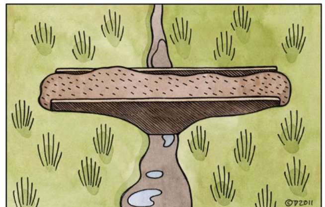
Figur 4.17. Exempel på en enkel typ av dämme för placering i mindre diken där det inte är lämpligt eller ekonomiskt rimligt att ta sig ut med maskiner. Dämmet utgörs av två skivor av hållbar, 20 mm tjock, plywood vars höjd och bredd överstiger dikets bredd och djup med cirka 0,5 m. Mellanrummet mellan skivorna fylls igen med tillgängligt material intill diket, exempelvis torv från myren och packas samman (illustrationer: Tupu Vuorinen).
