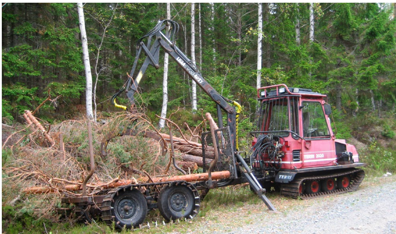
Figur 8.4. Terri 2020, bandgående skotare med relativt lågt marktryck som just varit inne i ett rikkärr och hämtat några tallstammar. Bromossen, medelrikkärr, Örebro län (foto: Jesper Hansson).
