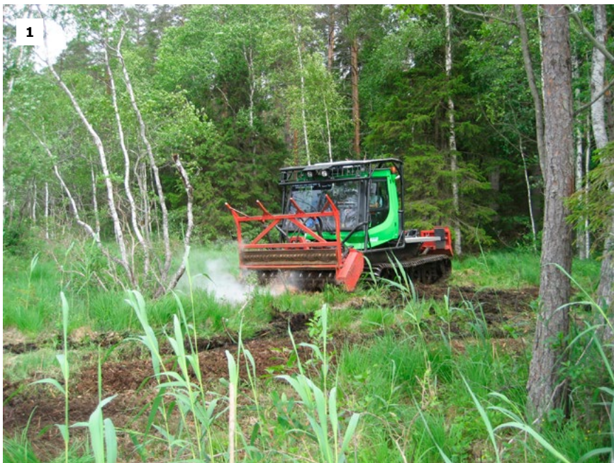
Figur 8.9. Pistmaskin, samma modell som i fig 8.8. Fräsning av stubbar till marknivå med pistmaskin. Bild 1. Pågående stubbfräsning. Bild 2. Fräsaggregat. Bild 3. Närbild på frästand (foto: Jesper Hansson).
