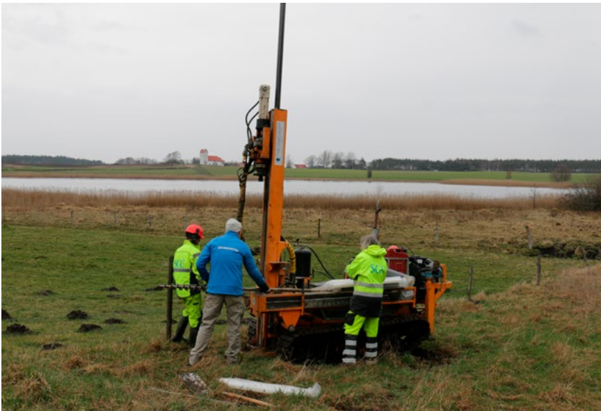
Figur 4.20. Hydrologer från SGU som använder maskin för att sätta rör för mera avancerad grundvattenmätning invid rikkärr i Skåne (foto: Kristian Nilsson).
