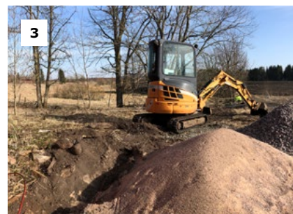
Figur 4.12. Lämpliga maskiner för stängselarbeten i rikkärr och andra blöta marker är lätta och oftast bandgående med lågt marktryck. Bild 1. En bandgående fyrhjuling med vagn. Bild 2. En bandgående stolpslagare. Bild 3. En bandgående minigrävare (foto: Jennie Niesel).
