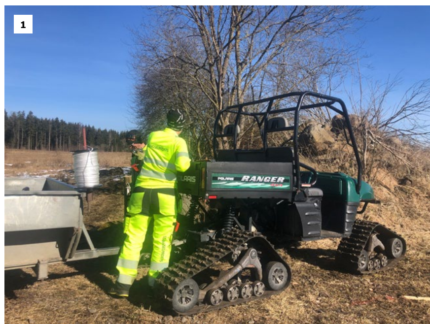
Figur 4.12. Lämpliga maskiner för stängselarbeten i rikkärr och andra blöta marker är lätta och oftast bandgående med lågt marktryck. Bild 1. En bandgående fyrhjuling med vagn. Bild 2. En bandgående stolpslagare. Bild 3. En bandgående minigrävare (foto: Jennie Niesel).
