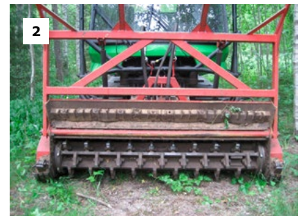
Figur 8.8. Pistmaskin, PistenBully 300 GreenTech, utrustad med slåtteraggregat och med balpress bakom styrhytten. Infälld är en närbild på de slagor som slår av gräs, starr, örter och förekommande sly (foto: Jesper Hansson).
