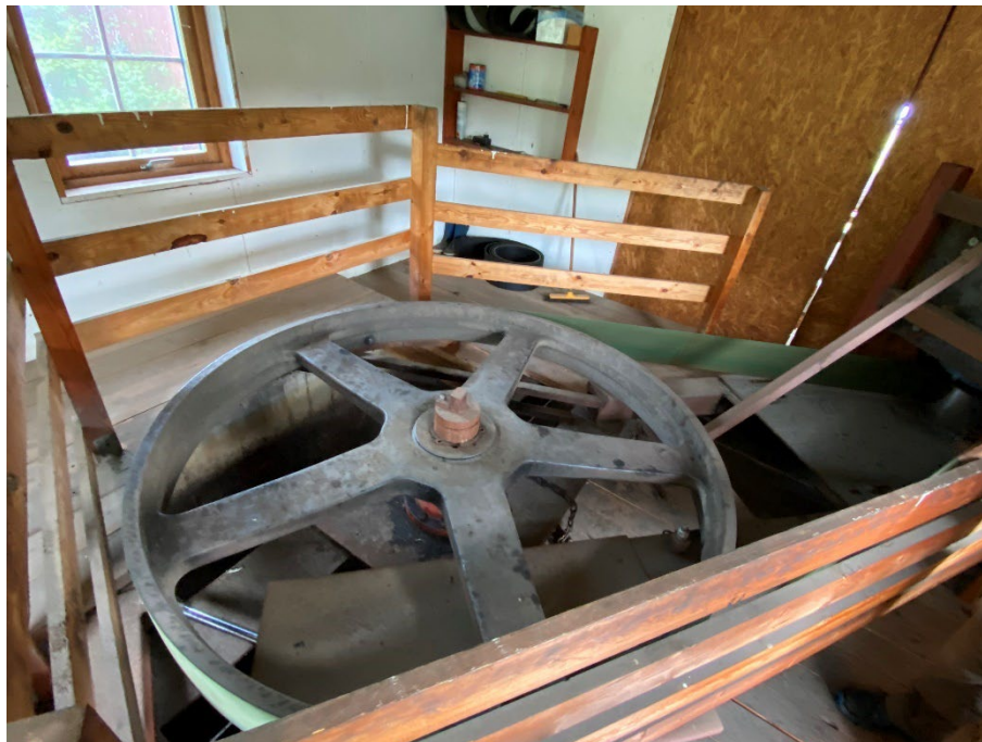
Figur 50. Kvarnens turbin med remväxel, i det utanpåliggande turbinhuset.
