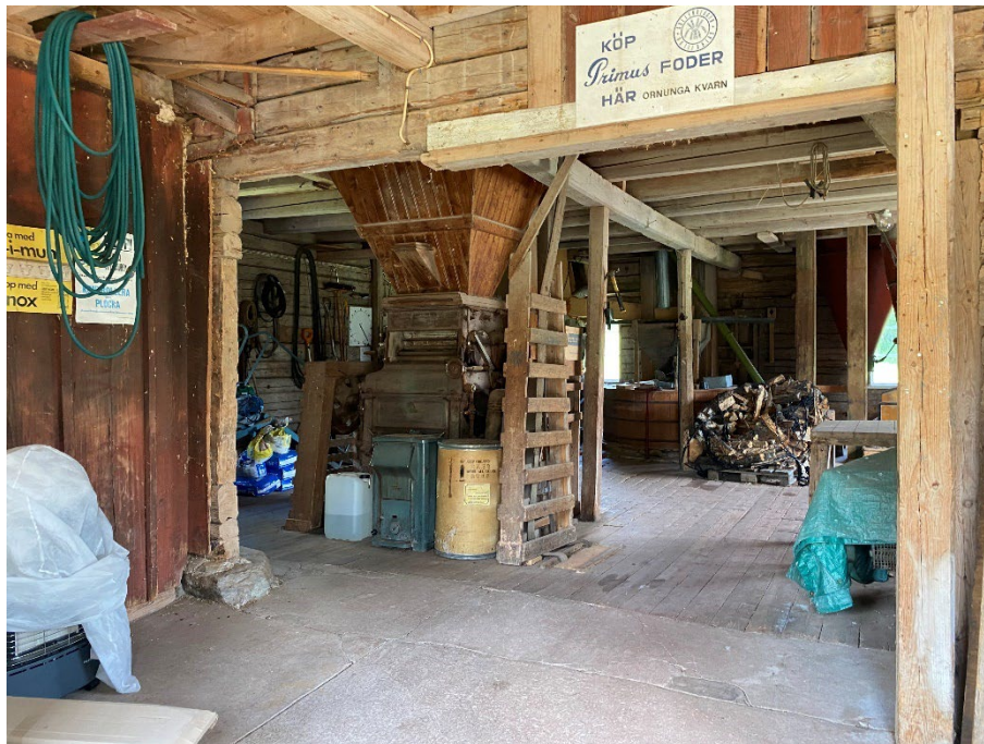
Figur 69. Kvarnens interiör med valsstol till vänster och kvarnstenarna i bakgrunden.
