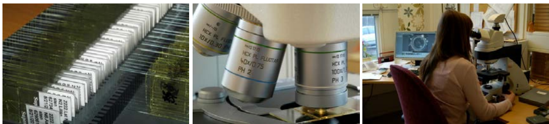
Figur 1. Prover för kiselalgsanalys prepareras kemiskt och kvarvarande kiselalgsskal fixeras på objekts-glas till permanenta preparat, som sedan kan analyseras i ljusmikroskop i 1000 gångers förstoring. Mikroskopet ska helst vara utrustat med interferenskontrast, vilket gör att man kan se mycket små former tydligare än med andra tekniker.
