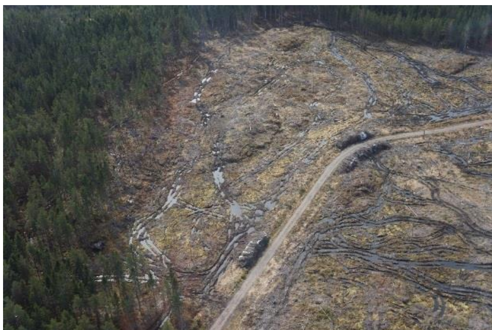
Bild 26. Körskador kan ge snabb avrinning. Markkompaktion kan göra skadorna bestående. Foto: Johan Hagström.
