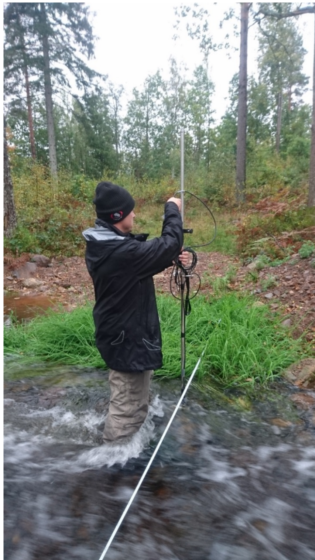
Figur 2 och 3. Vänster: Mätutrustning för fiskvägsinventeringen. Höger: Flödesmätning i tvärsnitt av omlöp.
