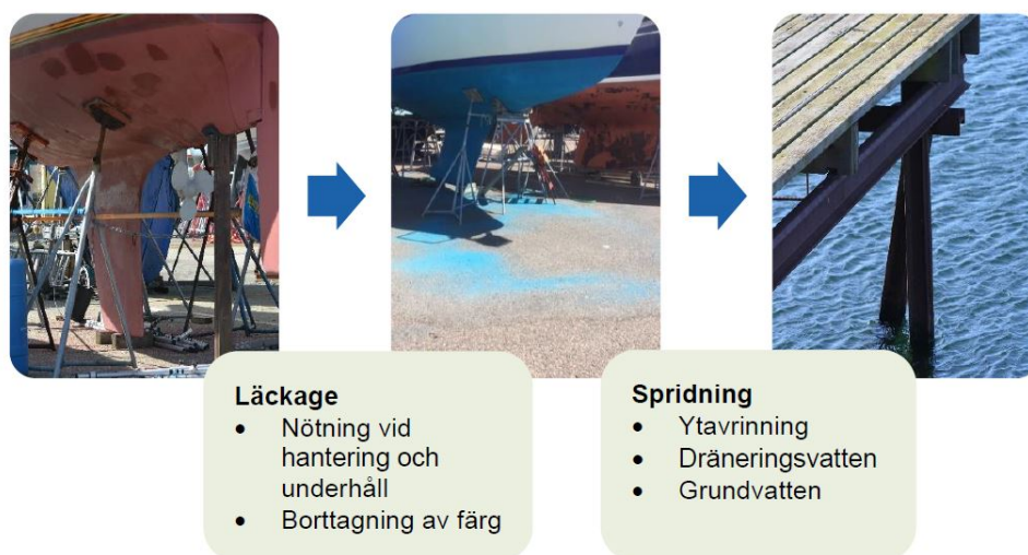
Figur 4 ”Schematisk bild av föroreningsspridning vid båtuppställningsplatser. Föroreningen tillförs området via båtarna, från vilka spridning sker till mark. För att förhindra detta kan ämnena tas bort från skroven eller läckagevägen brytas. Förorening i mark kan via vatten spridas vidare till sediment och ytvatten, där effekterna kan bli stora. För att förhindra detta kan den förorenade marken åtgärdas eller spridningen begränsas.” 104
