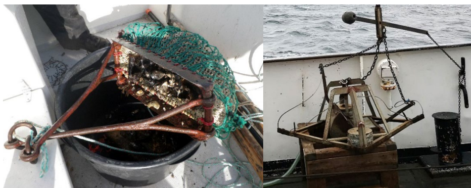
Figur 11. Skrapa (vänster) och bottenhuggare av typen Smith McIntyre (höger) är traditionell utrustning som används för att inhämta prover med hästmusslor.
