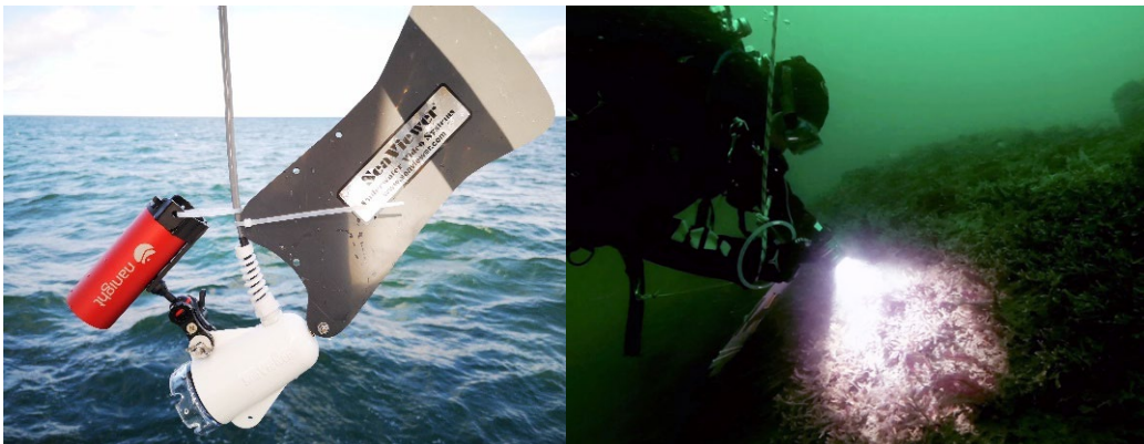
Figur 12. Dropvideokamera (vänster) samt dykning (höger) är visuella metoder som kan användas för övervakning av hästmusslor.
