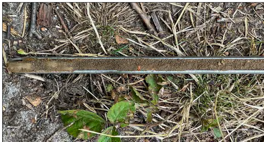
Figur 44. Provstick med obränd lera (längst t v) och tegel eller möjligen bränd lera (rött).
