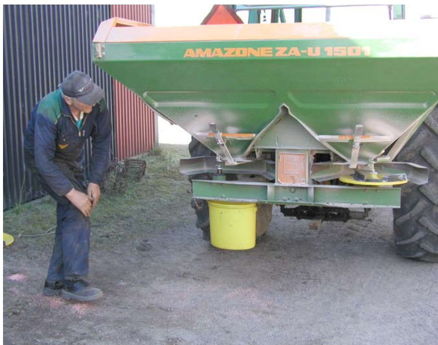
Kalibrering av handelsgödselspridare för rätt kvävegiva.
