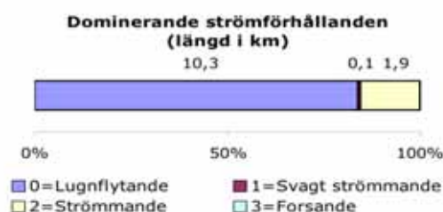
Figur 11. Fördelningen av de dominerande strömförhållandena i Simontorpsån. Längden av vattendraget där de olika förhållandena dominerar finns angivet i kilometer.
