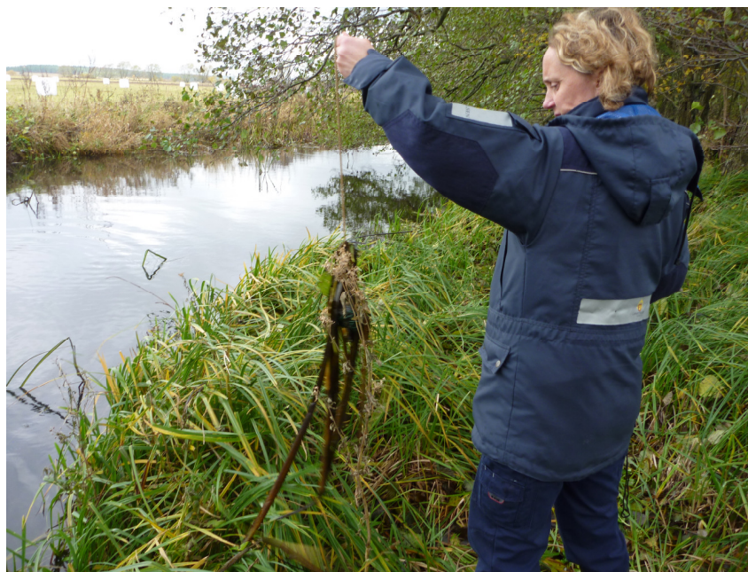
Figur 4. Vattenväxter i Klingavälsån har hämtats från åfårans mitt med hjälp av en dragg.
