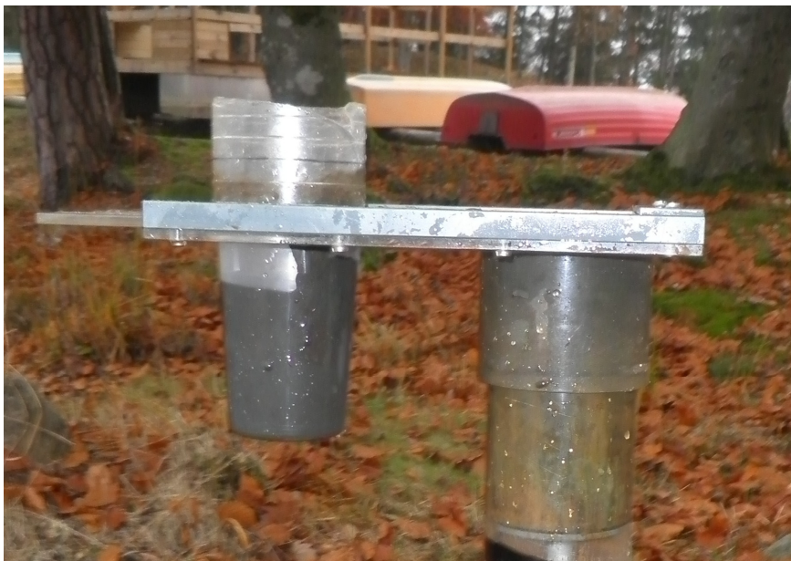
Figur 3. Närbild av sedimentskiktare som används till skiktning av sediment
