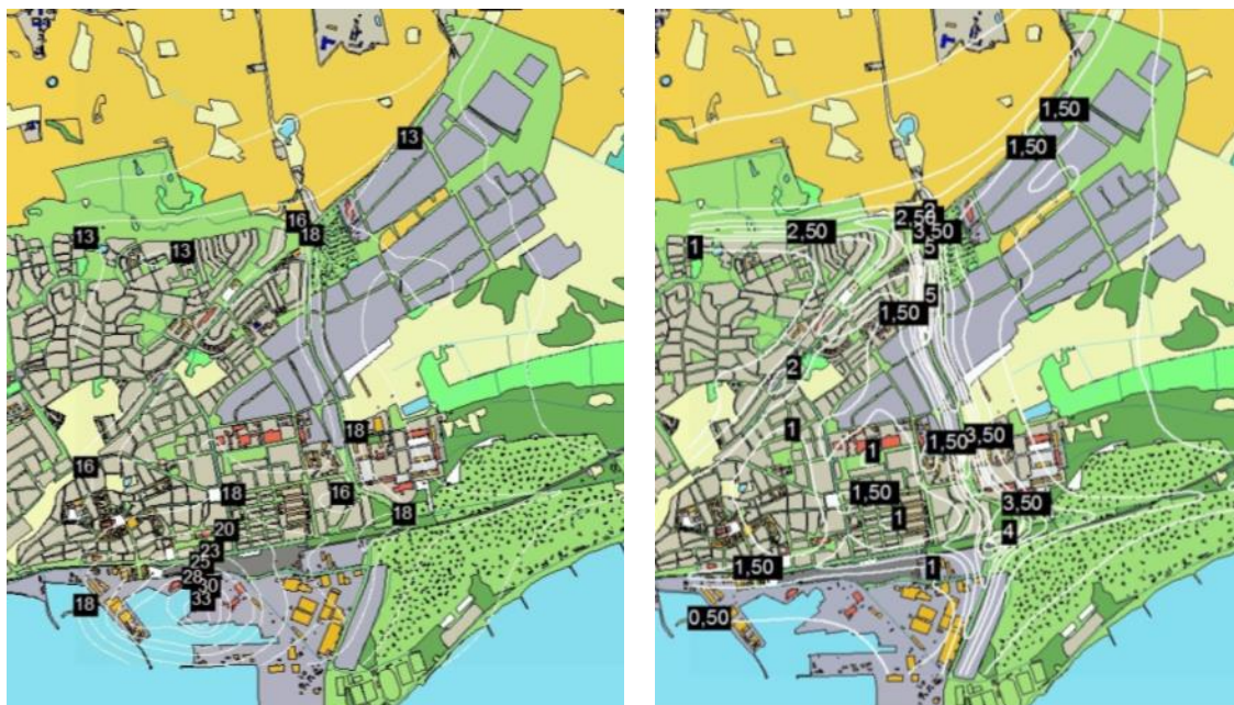
Figur 21. Beräknade kväveoxidhalter ( \text{NO}_x i \mu\text{g}/\text{m}^3 ) för Ystads NO industriområde och hamnområdet, till vänster avseende samtliga källor inklusive bakgrundshalt och till höger haltbidraget av kväveoxider ( \text{NO}_x i \mu\text{g}/\text{m}^3 ) från vägtransporter (lastbilar, lastbilar med släp och bussar).
