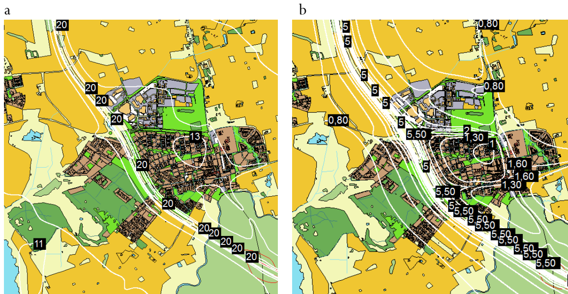
Figur 10a och b. Beräknade halter av kväveoxider från samtliga källor (a) respektive haltbidrag från vägtransporter (b), kring Europaväg 4 vid Åstorp (Åstorps kommun).
