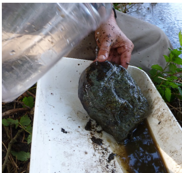
Figur 3. Vid kiselalgsprovtagningen hämtas minst fem slumpvis valda stenar från en representativ sträcka av vattendraget, varefter kiselalger och övrig påväxt borstas av från stenarna med en ren tandborste (överst). Materialet sköljs av och samlas upp i en vanna (underst). När alla stenar borstats blandas materialet i vannan noga och hålls i burkar. Burkarna förvaras svalt och mörkt. Efter att materialet har sedimenterat i burken hålls större delen av vätskan av och ersätts med etanol. Om stenar inte finns på lokalen läggs delar av friska vattenväxter i en burk med å- eller sjövattnen. Burken skakas kraftigt, så att kiselalger och annan påväxt lossnar, varefter vattenväxterna avlägsnas.
