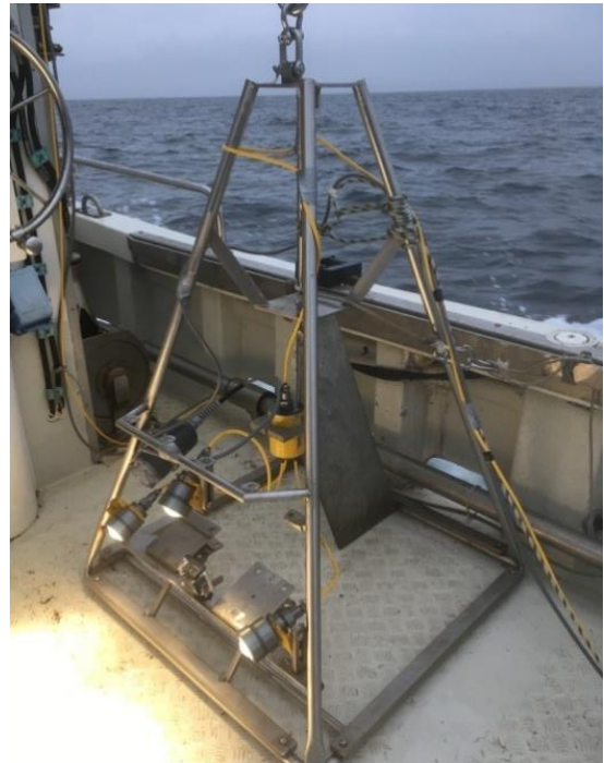
Videorigg med två undervattenskameror och tre LED lampor ombord på R/V Robusta.
