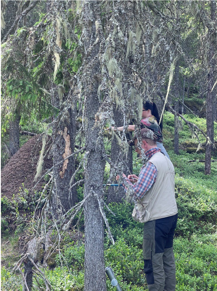
Figur 8. Anita Atrena och Bengt Gunnar Jonsson tar prov av årsringar i brösthöjd (1,3 m) för bestämning av trädens ålder och tillväxtmönster över tid. Foto P.-A. Esseen.
