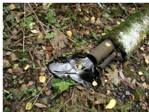
Figur 8. Olja som har runnit ur en ledning. Foto: Länsstyrelsen
