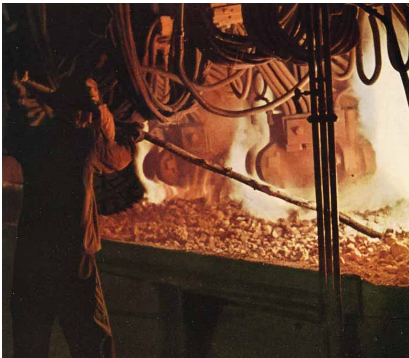
Närbild från arbetet vid karbidugnen i Ljungaverk. Ugnen var av öppen typ – utan lock – och det manuella arbetet var oerhört krävande i den enorma hettan från gaserna som strömmar upp runt elektrodena. I övre delen av bilden syns de kablar som för elektriciteten ned till elektrodhöljerna. Redskapet är gjort av en liten björkstam som förbrukas i takt med att den förbränns. Träet isolerar dock väl mot hettan. Foto ur Stockholms Superfosfat Fabriks Aktiebolag 1871-1946
