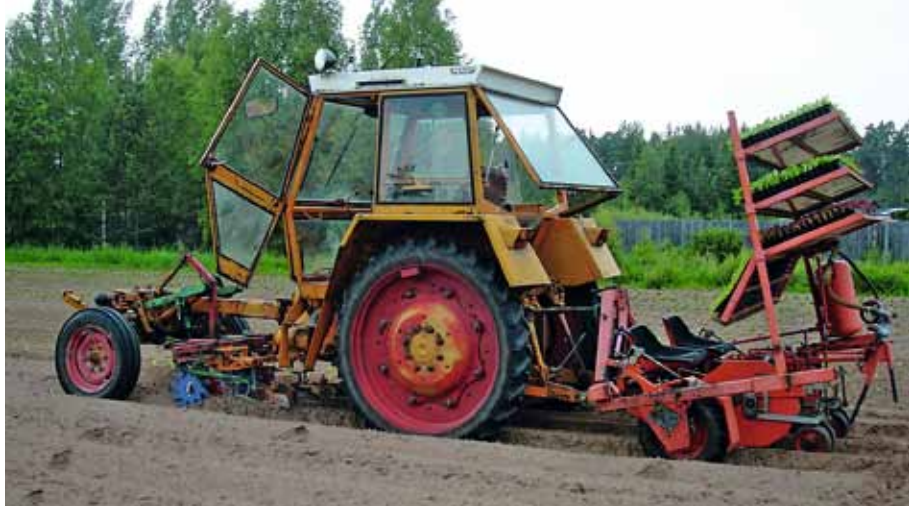
Redskapsbärare med hackor och hjul för ogrärensning samt planteringsmaskin av märket Wolf
