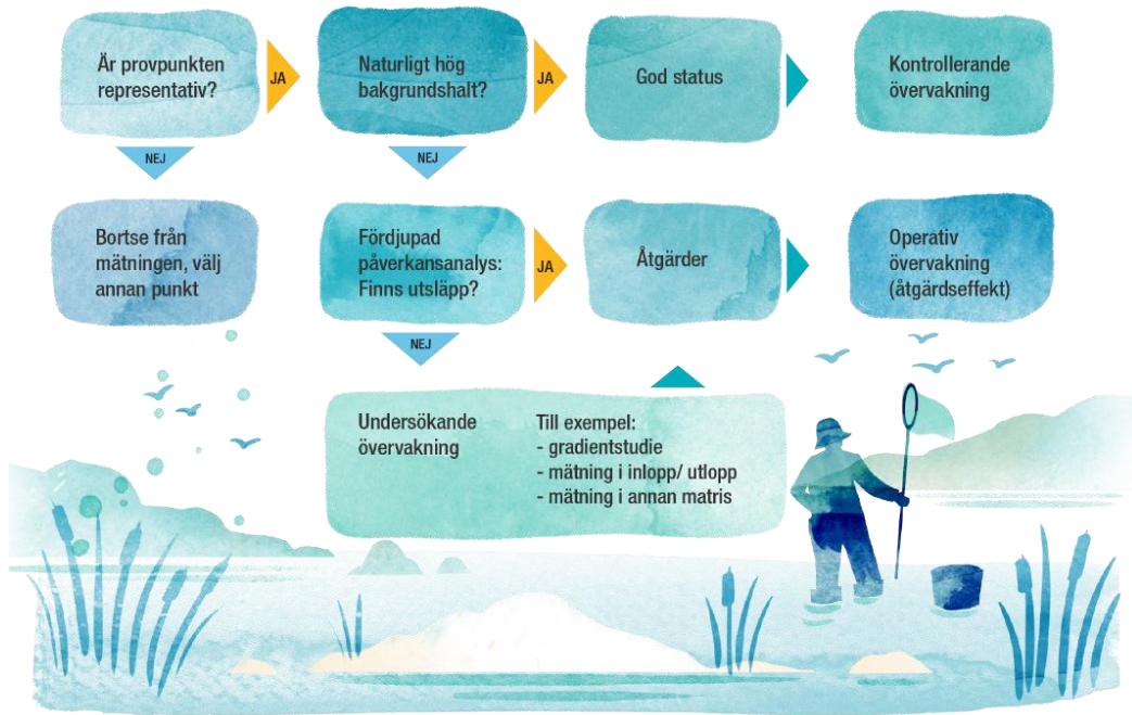
Figur 4.2 Strategin för undersökande övervakning när orsaken till att en vattenförekomst inte når en miljökoalitetensnorm är okänd. Flödesschemat visar de olika val och utredningar som till exempel en länsstyrelse behöver gå igenom innan de kan starta undersökande övervakning.
