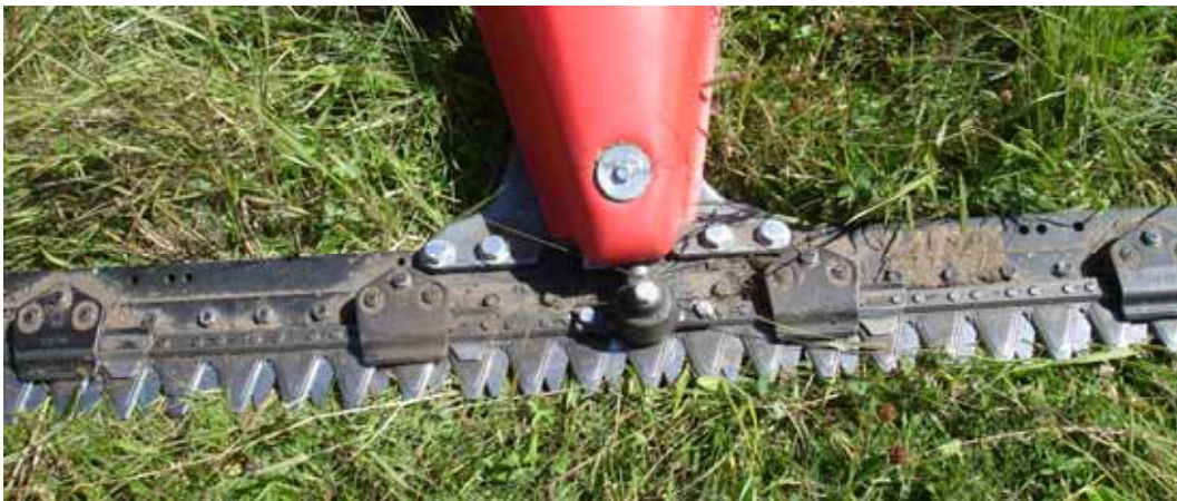
Figur 3. Vegetationen slås i "torr äng – hö" området med en tvåhjulstraktor utrustad med slåtterbalk. Nedre figuren visar slåtterbalken i detalj.
