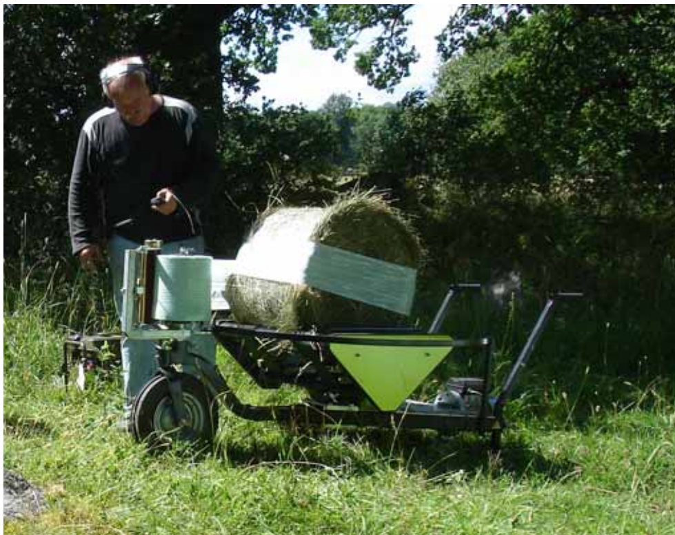
Figur 7. Vid inplastning av balar användes en ensilageinplastare med ett mobilt elverk.
