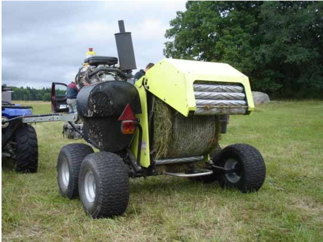
Figur 5. Den specialbyggda rundbalspressen med egen bensenmotor. Rundbalspressen drogs av en fyrhjulig motorcykel.
