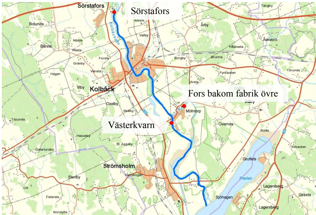
Figur 10. I vattenförekomsten (blått streck) finns fyra vandringshinder i form av dammar varav två är kraftverksdammarna Västerkvarn och Sörstafors. Två vandringshinder är regleringsdammarna Korsådammen och Intradammen som återfinns i den parallella fåra av Kolbäcksån som rinner genom Mölntorp. Elfiskelokalerna (röda prickar) ligger strax nedströms dammarna.
