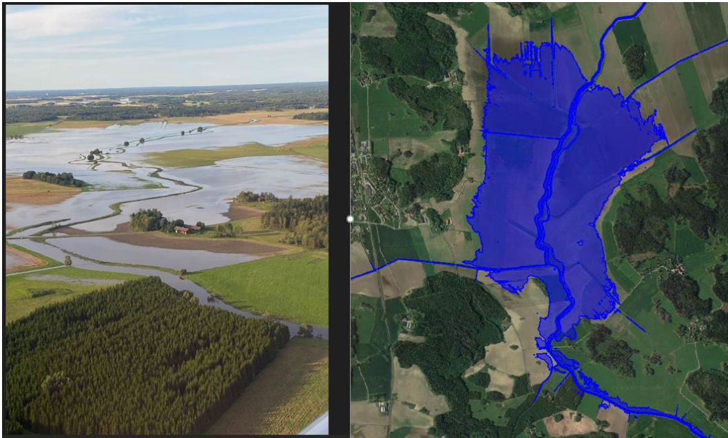
Figur 10 - Flygfoto 2023-09-06 (till vänster) och beräknad översvämningsutbredning vid bedömt flöde (till höger) på sträckan mellan Västtärna och Norr Hovberga.
