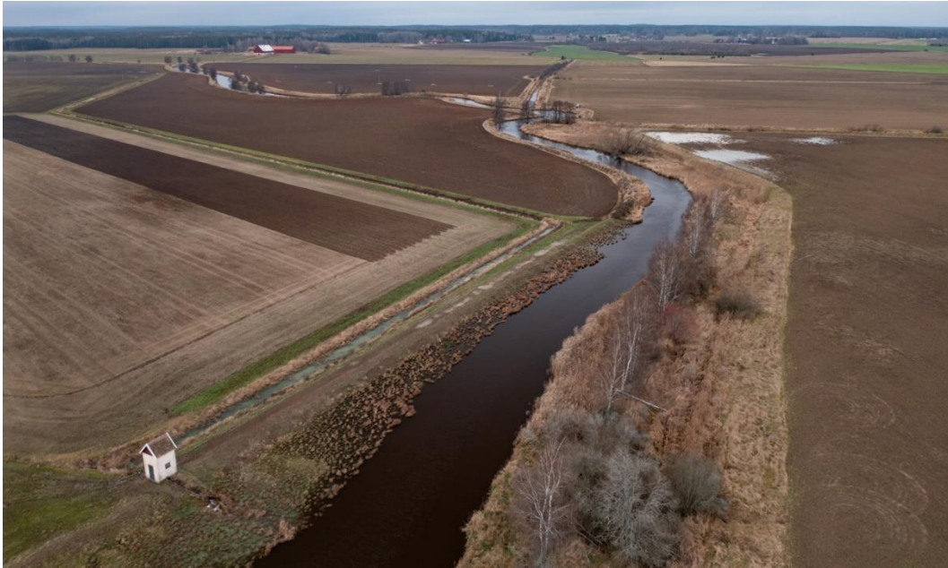
Figur 5. Drönbild (spridningstillstånd: LM2021/051624) över nedre delen av delsträcka 7 (uppströms Harakers kvarn). Här syns tydligt den fysiska påverkan i form av avsaknad av svämplan, närliggande brukad mark, rätning, invallning och grävda anslutande diken. Längst ned till vänster i bild syns ett pumphus för att dränera omgivande åkermark.
