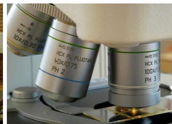
Figur 1. Kiselalgsanalys görs i ljusmikroskop i 1000 gångers förstoring med oljeimmersionsobjektiv. Mikroskopet ska helst vara utrustat med interferenskontrast, vilket gör att man kan se mycket små former tydligare än med andra tekniker.
