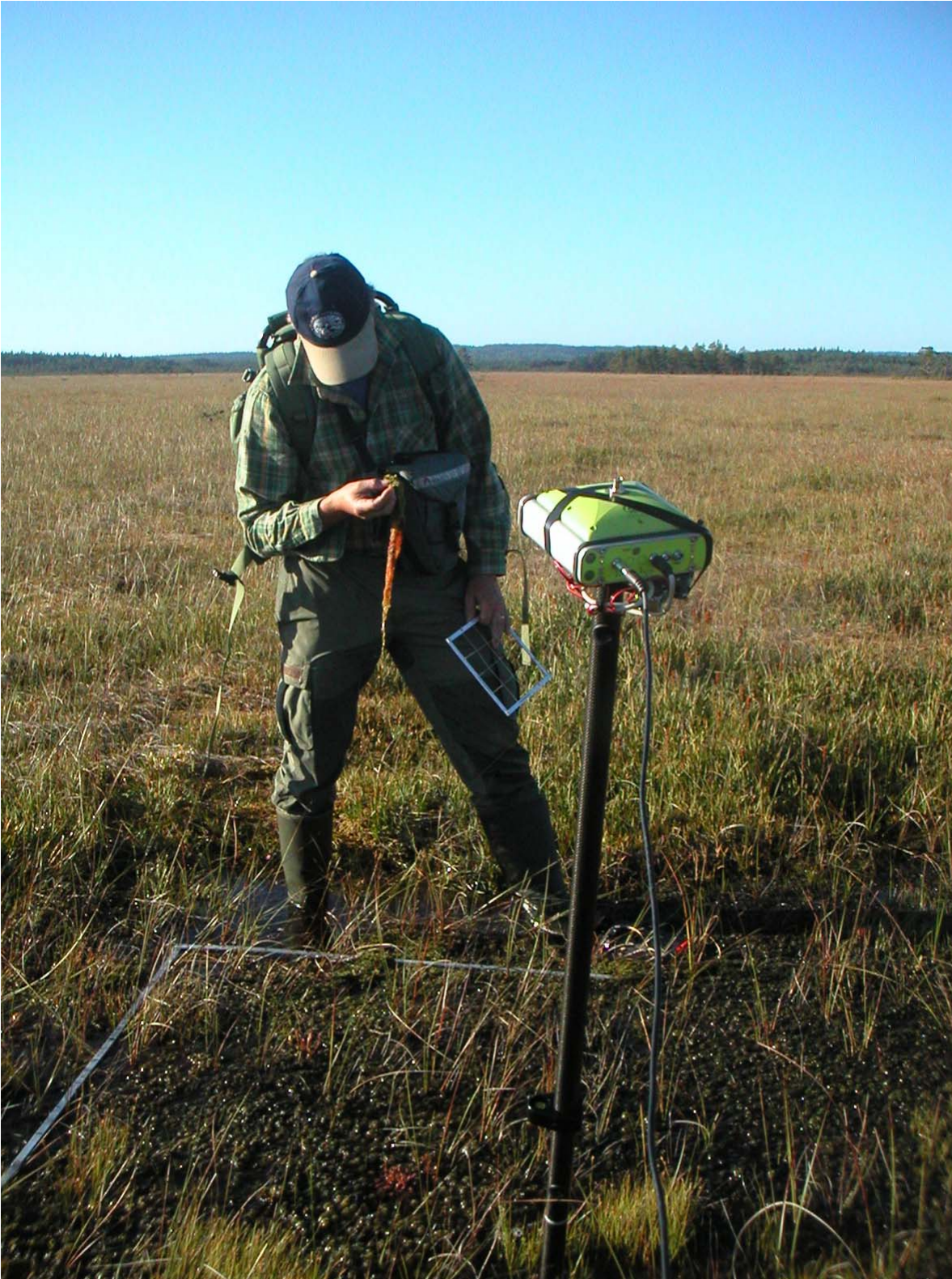
Figur 13. En högprecisions-GPS (Javad) uppkopplad mot Lantmäteriets RTK-tjänst (ger cm-noggrannhet) användes för att orientera till de ytor som skulle bedömas i fält. Urban Gunnarsson på Store Mosse nationalpark.
