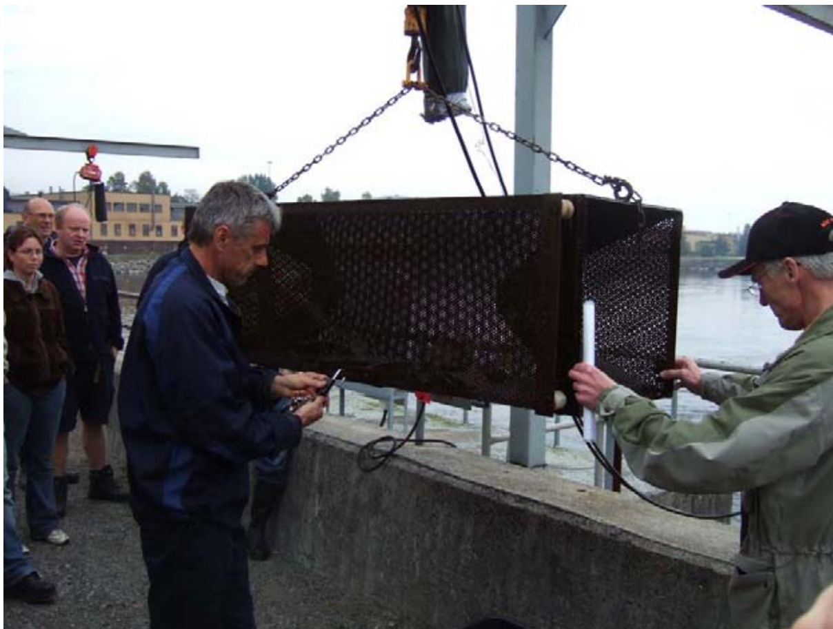
Figur 100. I Ljusnans mynning används fällor för att fånga och lyfta lekvandrande flodnejonögon vidare upp i vattensystemet. Metoden bör prövas även i Ätran i anslutning till Hertings kraftverk. Genom modifiering av fällans ingångshål bör metoden också vara applicerbar på havsnejonöga. Foto Nils Ljunggren.
