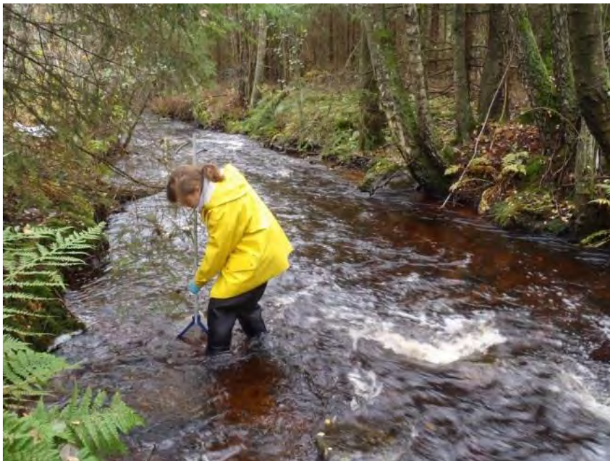
Figur 1. Provtagning med sparkmetoden.
