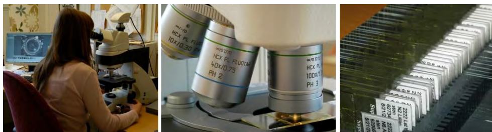
Figur 1. Kiselalgsanalys görs i ljusmikroskop i 1000 gångers förstoring med oljeimmersionsobjektiv. Mikroskopet ska helst vara utrustat med interferenskontrast, vilket gör att man kan se mycket små former tydligare än med andra tekniker.
