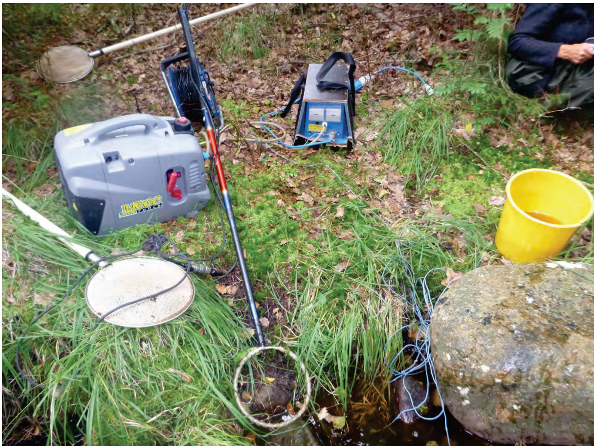
Elfiskeutrustning: håvar, bensinaggregat, elfiskestav med anodring kopplad med 50 meter kabel, likriktare, blå katodlina samt spann att överföra den fångade fisken.
