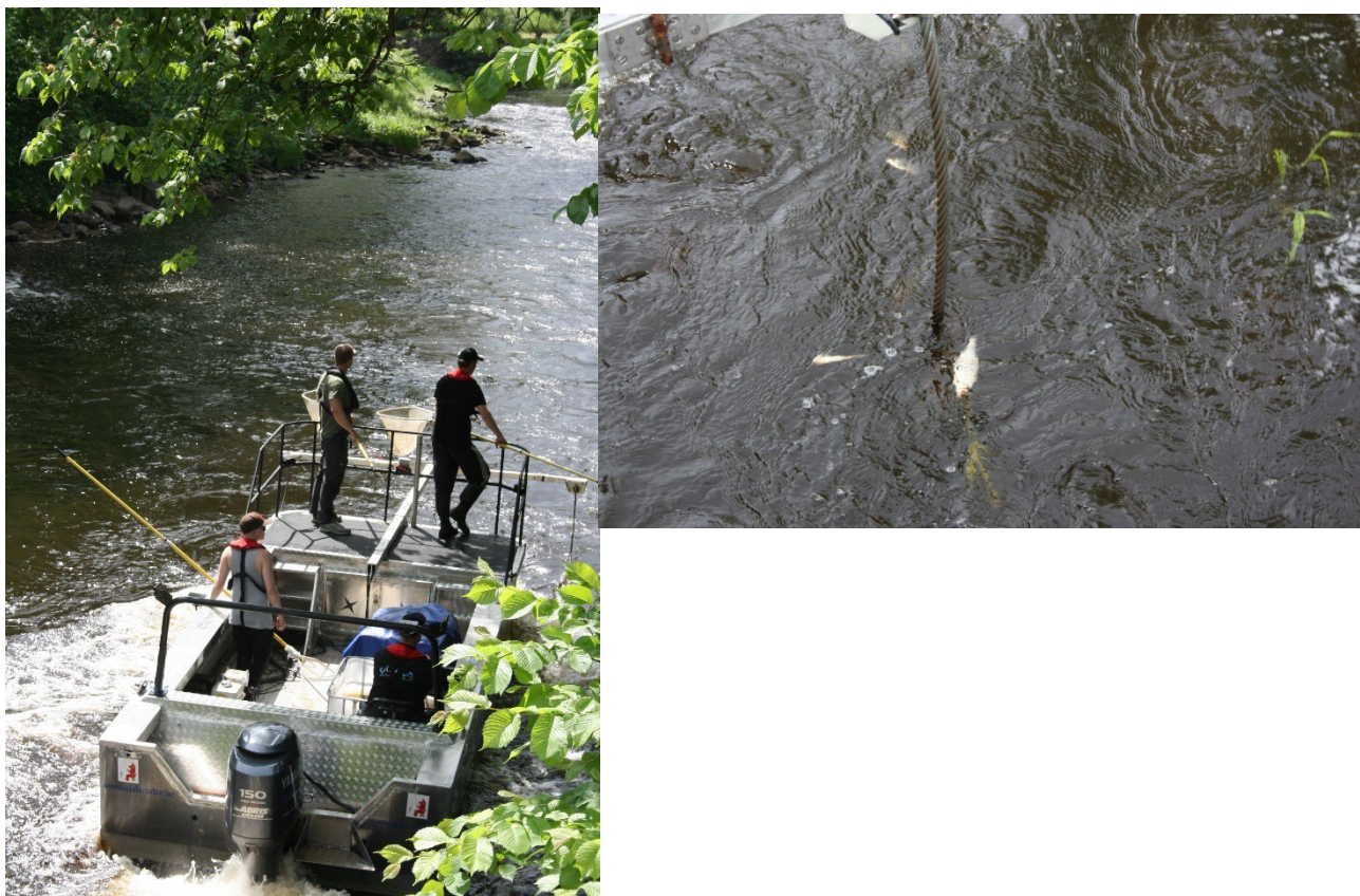
Figur 2a & 2b. Elfiskebåt av modell FAST och fisk vid anodelektrod. Foton: F.A.S.T.-Fiskeresursgruppen
