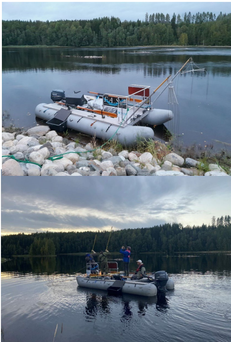
Figur 1a och 1b som visar elfiskebåt av modell Catacraft. Foton: Övre Matti Janhunen (Luke). Nedre Helena Haakana (ELY-keskus).
